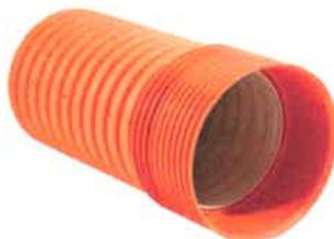
A tubagem a utilizar na rede de drenagem de águas pluviais, conforme descrito no mapa de quantidades e caderno de encargos, será o PP com perfil corrugado da classe de rigidez circunferencial específica SN8 (8 kN/m<sup>2</sup>) o diâmetro de 200mm.
