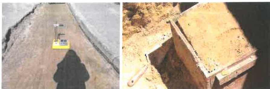
Ensaio "in-situ" - Gamadensímetro "Troxler"
