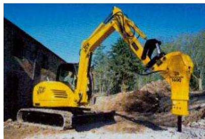
Mini-giratória com martelo hidráulico para escavações em rocha dura
