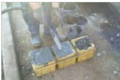
Figura 8 – Execução de provetes
