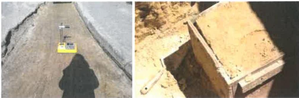
Ensaio "in-situ" - Gamadensímetro "Troxler"
